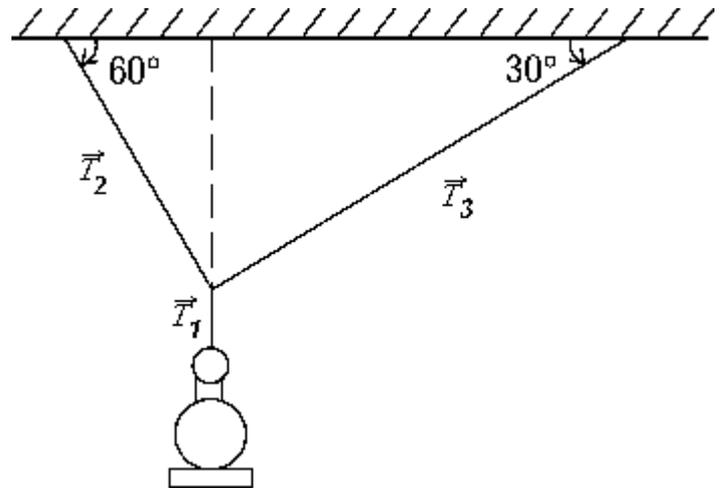
No corpo  $T_1 = mg$ , no ponto de encontro dos 3 fios  $\vec{T}_1 + \vec{T}_2 + \vec{T}_3 = 0$ .
